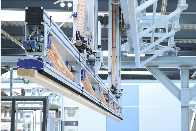
Sistema de planos aspirantes FMP-S apilando por capas madera para la construcción
